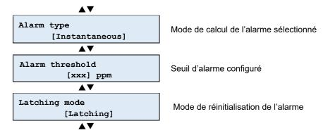
(i) Les sous-menus « *Alarm threshold* » et « *Latching mode* » sont uniquement visibles si le niveau d'alarme correspondant est activé.
