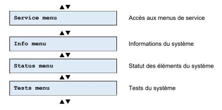
La navigation dans les menus est réalisée à partir des touches directionnelles du clavier et la sélection à l'aide de la touche « **ENTER** ».
