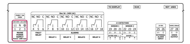
Le central U•C2 doit pouvoir être isolé électriquement en cas d'intervention (protection par disjoncteur ou un interrupteur bipolaire).
