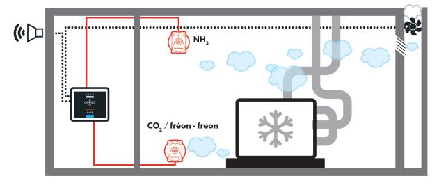
Le central U•C2 dispose également d'une gestion des défauts internes. Une fois détecté, tout fonctionnement anormal du central ou d'un détecteur est notifié par une action sur un relais signalant le défaut technique. Cette fonction assure ainsi la fiabilité du système de détection de gaz installé.
