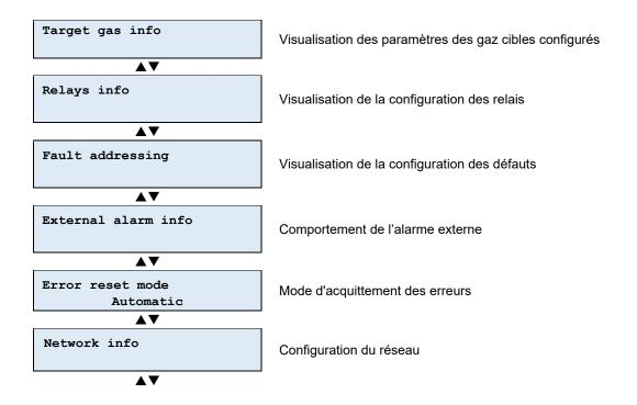
La navigation dans les menus est réalisée à partir des touches directionnelles du clavier et la sélection à l'aide de la touche « **ENTER** ».
